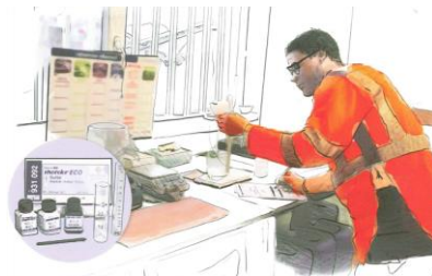
DOSAGE RAPIDE DES SULFATES DANS LES GRANULATS RECYCLÉS SUR SITE
